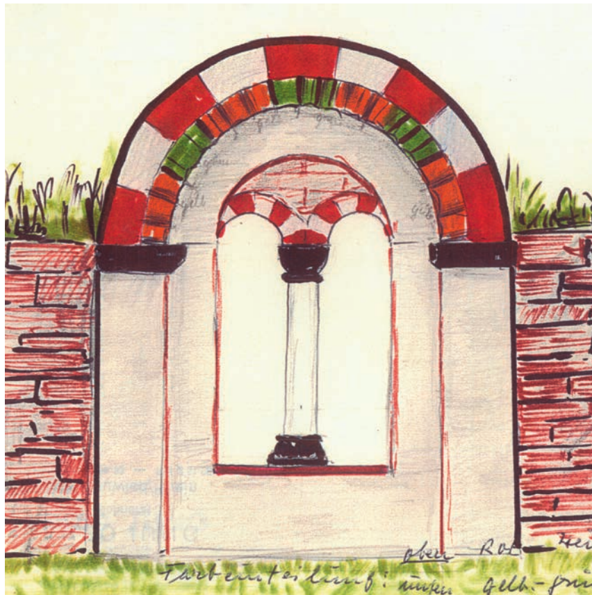
Abb. 16: Neuerburg, Farbbefund an den Biforienfenstern im Erdgeschossaal (Zeichnung: Theo Jung)
